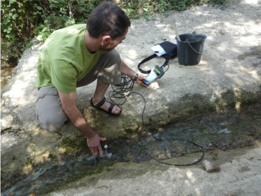
FIGURE 3.3 – Jaugeage conductimétrique d'un cours d'eau dans le département de la Drôme - Août 2009
