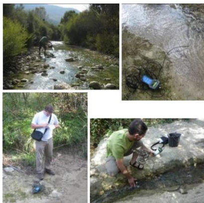
Photographies de jaugeages ponctuels effectués par Sogreah lors de l'étude EVP (méthode par dilution de sel)
